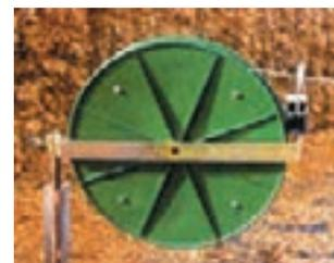
Enrollador automático provisto de 40m. de cordón y manilla A-17. Equipado con un muelle en espiral que mantiene tensada la cuerda y la auto enrolla al soltar el extremo. Diámetro exterior: 36 cm. Ancho: 4,5 cm.
