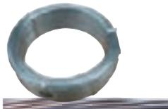
Cable (buen conductor) de alambres suaves de unos 2 mm.  $\varnothing$ . Rollos de 200 metros. 0,14 ohmios/m. +/- Carga de rotura: aprox. 60 kg.
