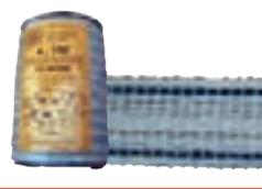
Cinta de 20 mm. de ancho en nylon blanco con bordes azules, 6 conductores de acero inoxidable de 0,20 mm.  $\varnothing$ . Rollos de 200 metros. 3,5 ohmios/m. +/- Carga de rotura: aprox. 130 kg.
