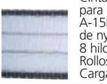
Cinta de 4 centímetros de ancho (se usa para caballos, aunque es suficiente la A-15 ó A-15B), compuesta por 8 monofilamentos de nylon de color blanco con bordes grises y 8 hilos de acero inoxidable de 0,40 mm.  $\varnothing$ . Rollos de 200 metros. 1,4 ohmios/m. +/- Carga de rotura: aprox. 300 kg.
