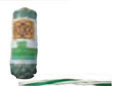
Hilo de nylon blanco y verde de tres conductores de acero inoxidable de 0,20 mm.  $\varnothing$ , especial para jardines. Rollos de 100 metros. 8 ohmios/m. +/- Carga de rotura: aprox. 45 kg.
