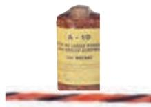
Hilo de nylon naranja y negro con tres conductores de acero inoxidable de 0,20 mm.  $\varnothing$ . Rollos de 200 metros. 7 ohmios/m. +/- Carga de rotura: aprox. 50 kg.
