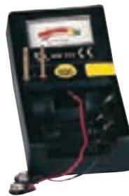
Comprueba todo tipo de pilas. Está provisto de conectores especiales para modelos A-22, A-26A y A-127. Una vez conectada la pila conviene esperar unos segundos para ver si se mantiene la aguja, pues lleva una carga interna (consumo). Si se estabiliza en la franja verde es que está bien, en la amarilla, regular y en la roja, mal. No necesita pila.
